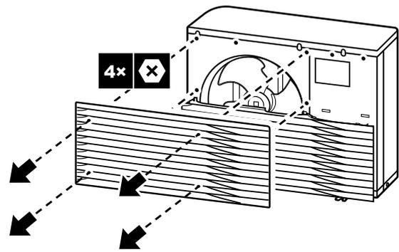
2 Entfernen Sie den unteren Teil des Auslassgitters.
