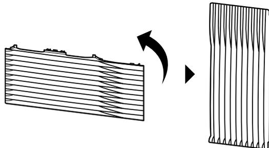
4 Richten Sie den Kugelbolzen aus und haken Sie das Gitter an seinem Gegenstück am Gerät ein.
