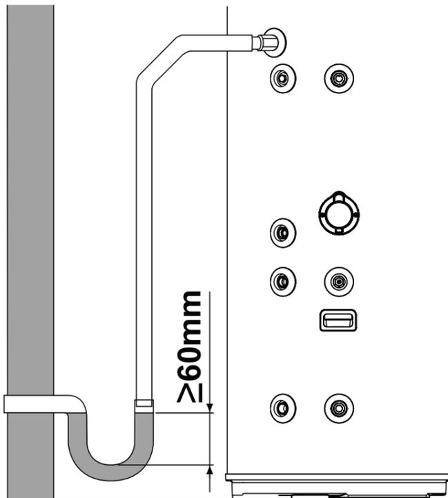
Abb. 18 - Beispiel für einen Kondensatablaufanschluss über einen Siphon
