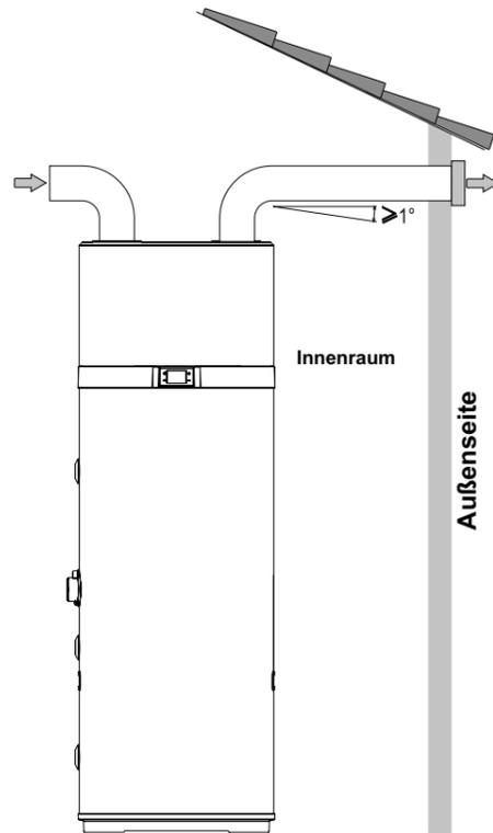
Abb. 12 - Beispiel für einen Luftauslassanschluss
