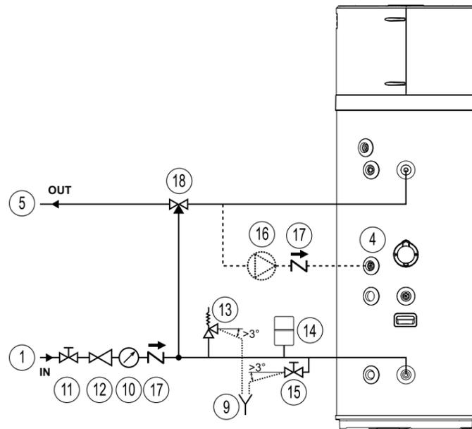
Abb. 17 Beispiel für das Wassersystem
