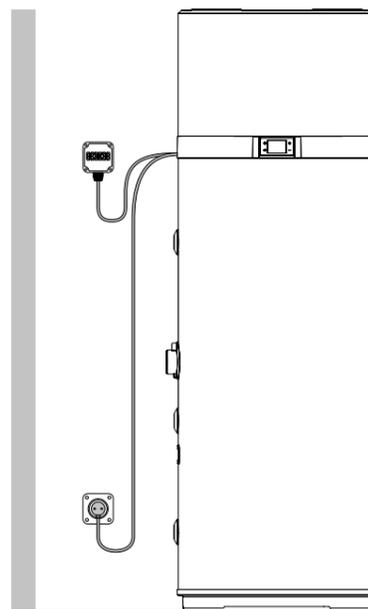
Abb. 24 - Beispiel für eine Fernverbindung
