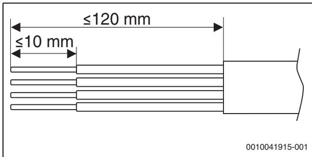
Bild 31 Abisolierung CAN-BUS
