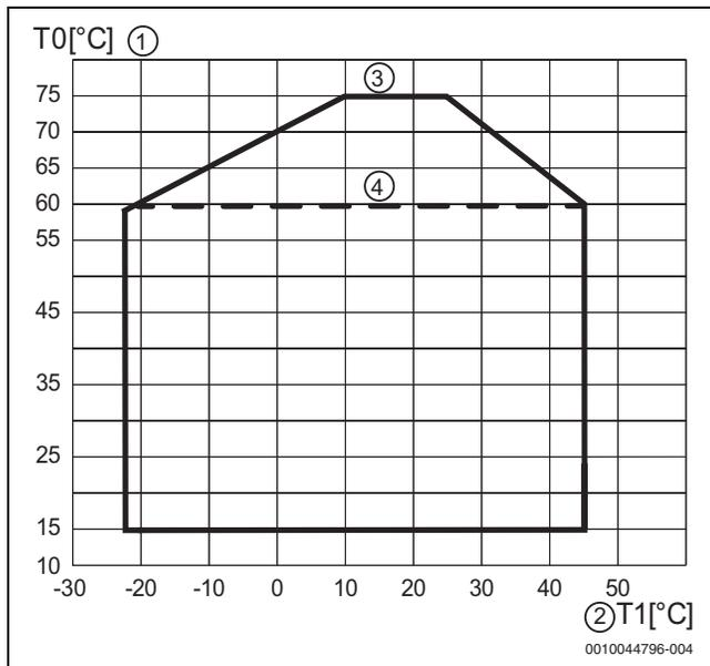
Bild 40 Wärmepumpe im Heizbetrieb ohne Zuheizler
