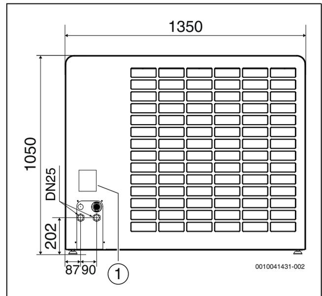
Bild 4 Abmessungen und Anschlüsse der Wärmepumpe, Rückseite
