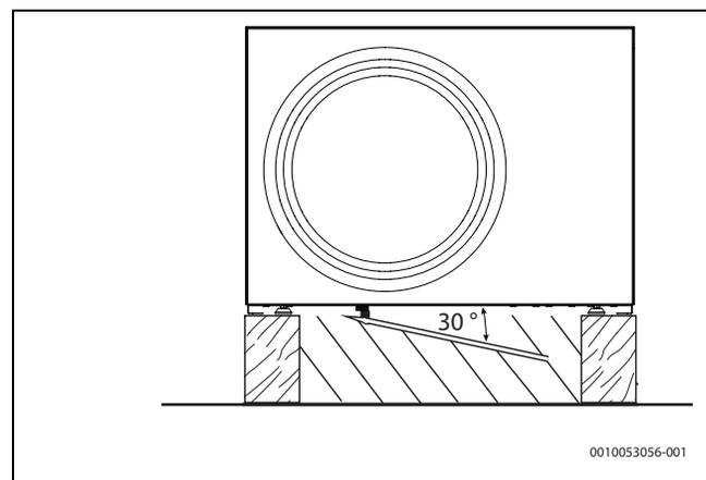
Bild 23 Installation des Kabels für die Tropfschalenheizung
