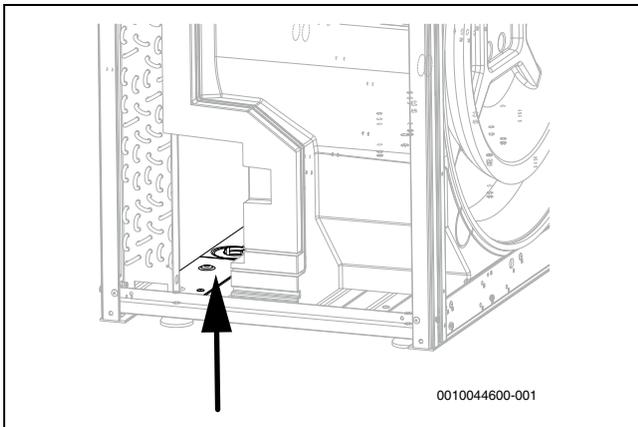
Bild 38 Tropfschale reinigen
