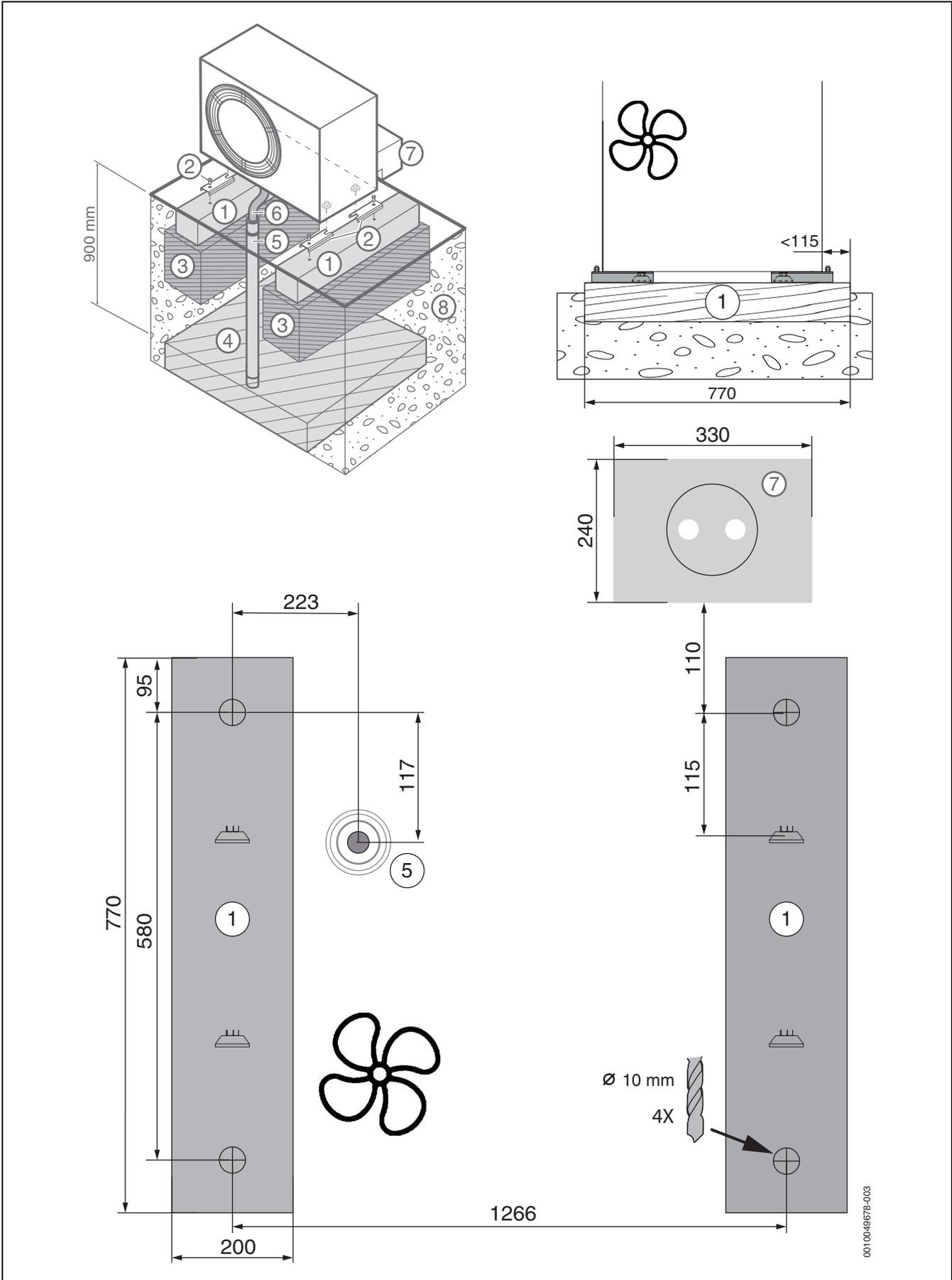
Bild 21 Fundamentplan, Alternative 1
