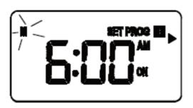
Das Betätigen der SET-Taste im Programmiermodus bringt den EP200 zurück in den Normal-Modus. Drücken Sie die AUSWAHL-Taste, um die Tagesauswahl zu bestätigen. Nachdem diese eingestellt wurde, blinkt die "Hour" (Stunden)-Anzeige und zeigt damit an, dass diese ausgewählt ist und als nächstes angepasst werden kann:
