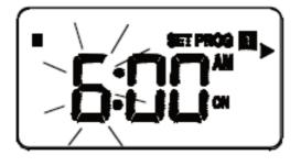
Betätigen Sie die NACH OBEN- oder NACH UNTEN-Taste, um die Stundeneinstellung auf den gewünschten Wert anzupassen und bestätigen Sie Ihre Auswahl durch Betätigen der AUSWAHL-Taste. Gehen Sie beim Anpassen der "Minuten"-Einstellung genauso vor.
