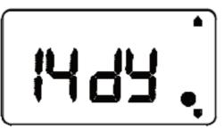
sofort ab. Die Anzeige des EP200 wird daraufhin die Anzahl der Tage anzeigen, für die das System abgeschaltet bleibt - diese Anzeige verringert sich jeweils um Mitternacht.
