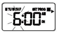
Drücken Sie die AUSWAHL-Taste, um die Wochentagoder Wochenendauswahl zu bestätigen. Nachdem diese eingestellt wurde, blinkt die "Hour" (Stunden)-Anzeige und zeigt damit an, dass diese ausgewählt ist und angepasst werden kann:
