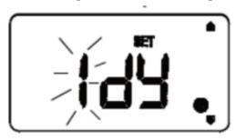
Sie können nun durch die NACH OBEN- und NACH UNTEN-Tasten die Anzahl der Tage, während denen das System abgeschaltet ist, erhöhen oder verringern. Die maximale Tagesanzahl beträgt 31 -
