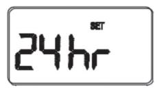
Lassen Sie die SET- und AUSWAHL-Tasten los und betätigen Sie die NACH OBEN- oder NACH UNTEN-Taste um zwischen dem 12- und 24- Stundenformat hin- und her zu schalten.
