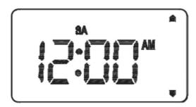
Alle Einstellungen kehren zu den Standardwerten zurück. Bei Betätigen der Reset-Taste verhält sich der EP200 wie oben beschrieben, zusätzlich werden alle zuvor vom Benutzer gespeicherten Einstellungen gelöscht und mit den Standardeinstellungen ersetzt.
