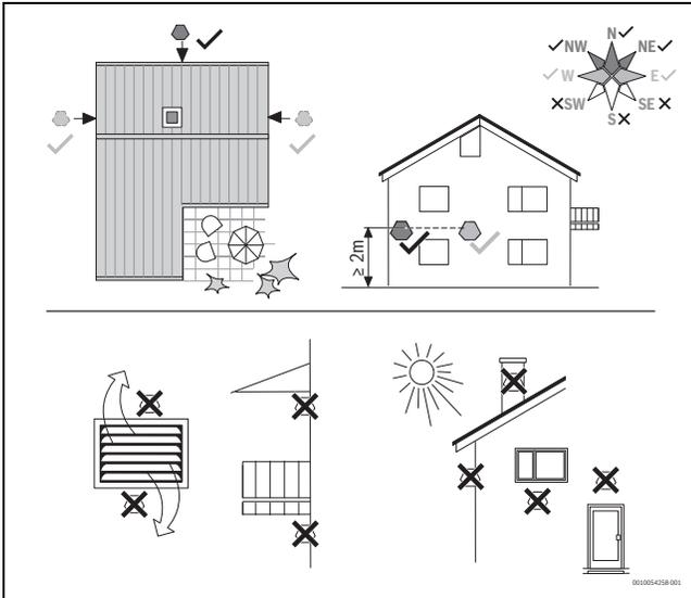
Bild 2 Geeigneter und ungeigneter Installationsort des Außentemperaturfühlers
