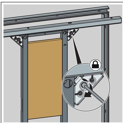
► Das Element mit Prevista Dry Plus-Schiennenverbindern befestigen.
