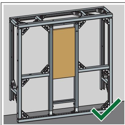
⇒ Das Element ist in der Prevista Dry Plus-Vorwandkonstruktion befestigt.
