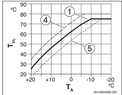
**Bild 15** Einstellung der Heizkurve für Heizkörper
