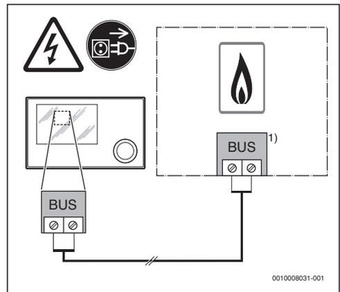
Bild 7 Anschluss der Bedieneinheit an einem Wärmeerzeuger
