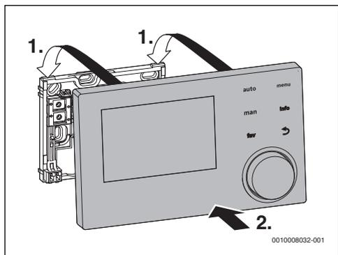
Bild 8 Bedieneinheit einhängen
