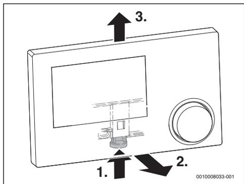
Bild 9 Bedieneinheit abnehmen
