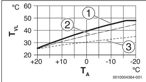
**Bild 12** Einstellung der Heizkurve für Fußbodenheizung
