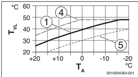
**Bild 13** Einstellung der Heizkurve für Fußbodenheizung
