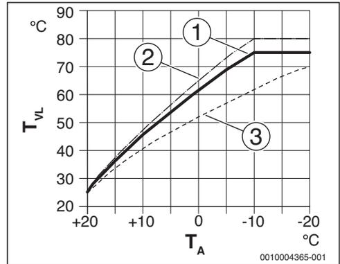
**Bild 14** Einstellung der Heizkurve für Heizkörper
