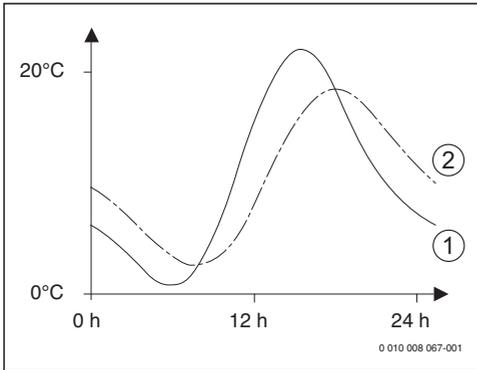
Bild 11 Beispiel für die gedämpfte Außentemperatur
