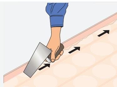
Sobald die Oberfläche begehbar ist, wird die überschüssige Füllmasse mit einer Spachtel oder Kelle entfernt.
