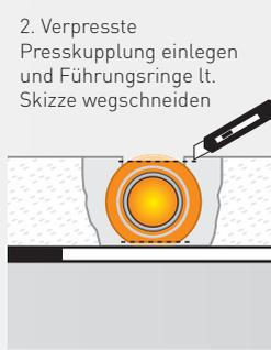
2. Verpresste Presskupplung einlegen und Führungsringe lt. Skizze wegschneiden
