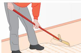
Innerhalb von 3 Stunden (bei 20 °C) nach Einbringen der Kompakt-Füllmasse wird eine 2. Schicht Kompakt-Füllmasse aufgebracht.
