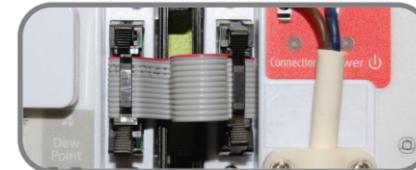
**13** Schalten Sie die Stromzufuhr zur KL04RF ein. Die rote LED leuchtet auf.
