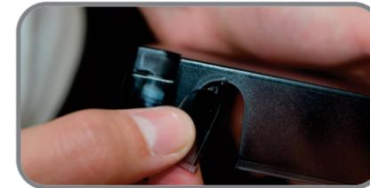
**3** Befestigen Sie die Rückseite der KL04RF an der DIN-Schiene oder der Wand. Falls Sie die KL04RF an der Seite der KL08RF anbringen, verwenden Sie die kurze Flachbandleitung, ansonsten die längere (siehe Schritt 10). Im Folgenden ist die seitliche Wandmontage dargestellt
