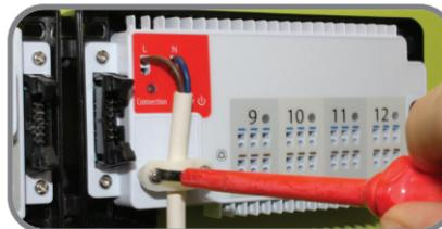
**10** Verwenden Sie das kurze Flachbandkabel zwischen KL08RF und KL04RF für eine seitliche Montage. Ansonsten das längere Flachbandkabel. Im Folgenden ist die seitliche Montage dargestellt:
