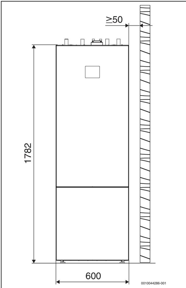
Bild 3 Abmessungen (mm)
