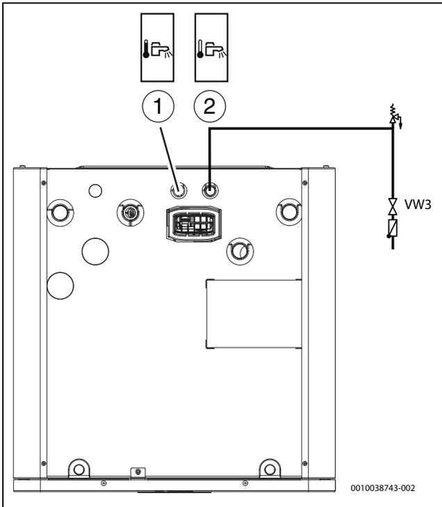
Bild 23 Wärmepumpenanschlüsse Trinkwasser
