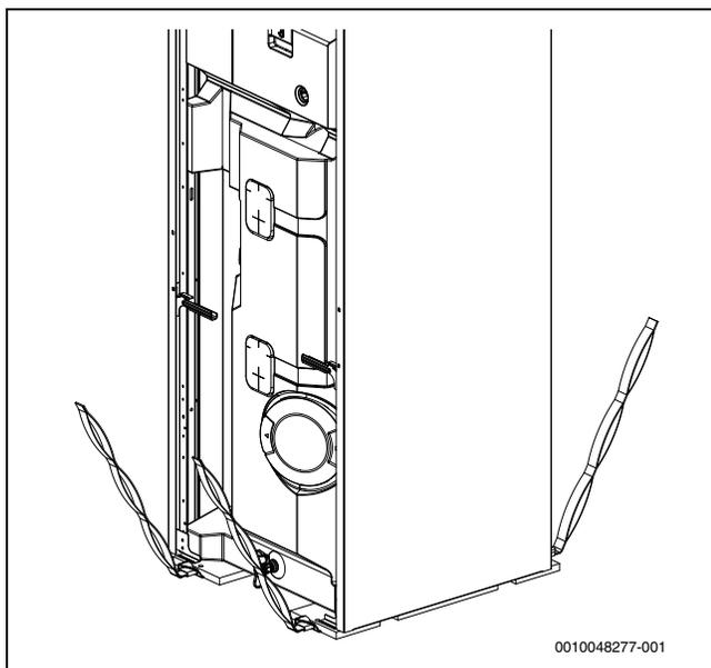
Bild 15 An der Inneneinheit befestigte Halterungen und Gurte
