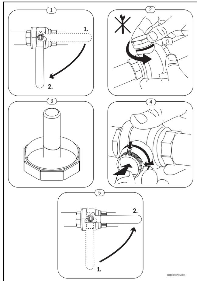
Bild 43 Siebreinigung
