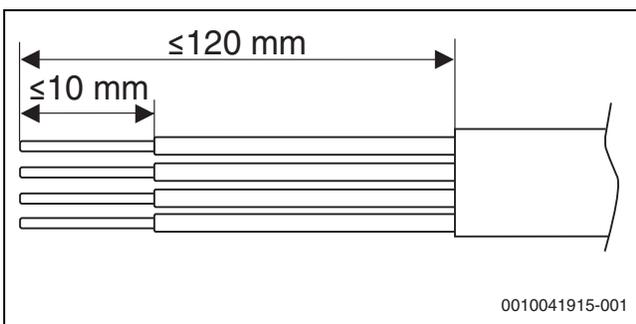
Bild 26 Abisolierung CAN-BUS
