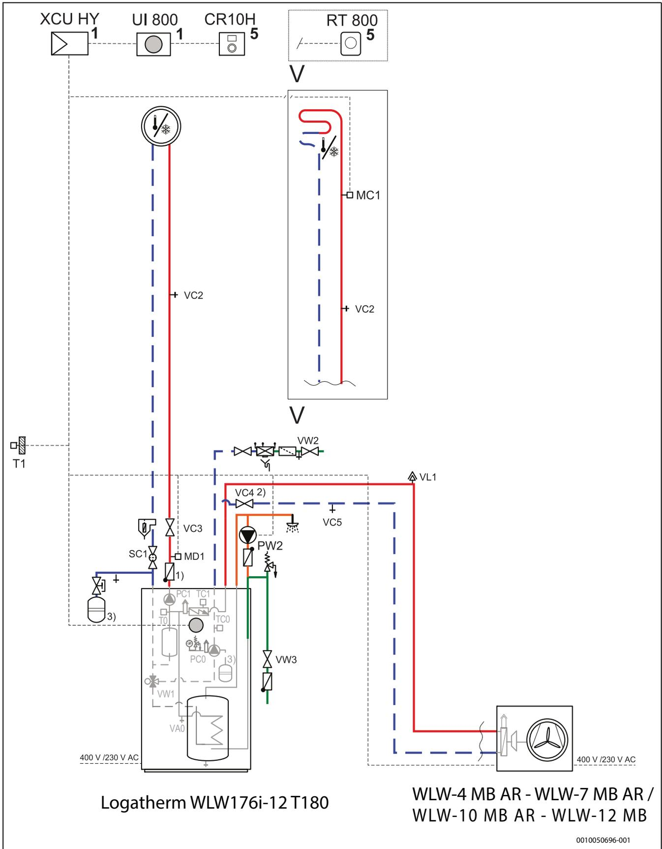
Bild 46 Tower Inneneinheit, Wärmepumpe (ODU), ein ungemischter Heizkreis
