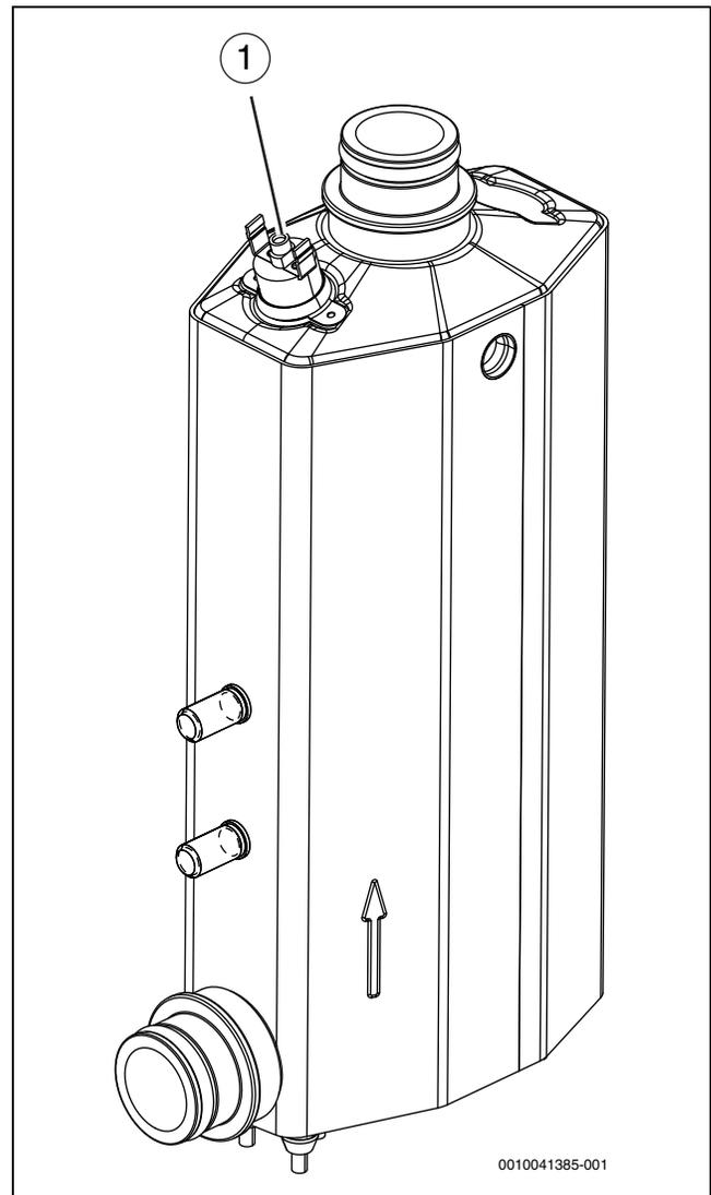
Bild 42 Elektrischer Zuheizer
