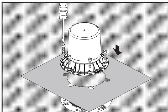
Dichtmanschette über das Kunststoffgehäuse des Grundsets stülpen und in den Kleber eindrücken.
