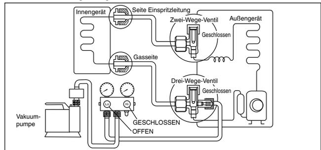
1. Einen Füllschlauch mit einem Druckstift an die Niederdruckseite der Ladestation und an den Service-Anschluss des 3-Wege-Ventils anschließen.
