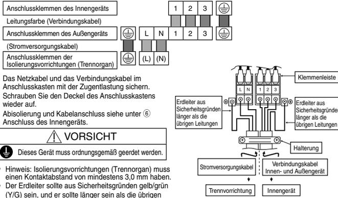
5. Das Netzkabel und das Verbindungskabel im Anschlusskasten mit der Zugentlastung sichern.
