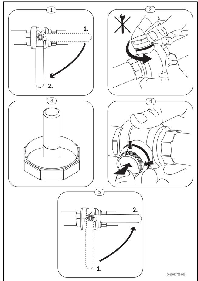
Bild 14 Partikelfilterreinigung
