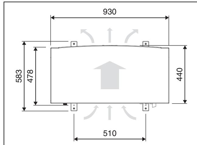
Bild 5 Abmessungen der Wärmepumpenmodelle 4.2-8.2, Ansicht von oben
