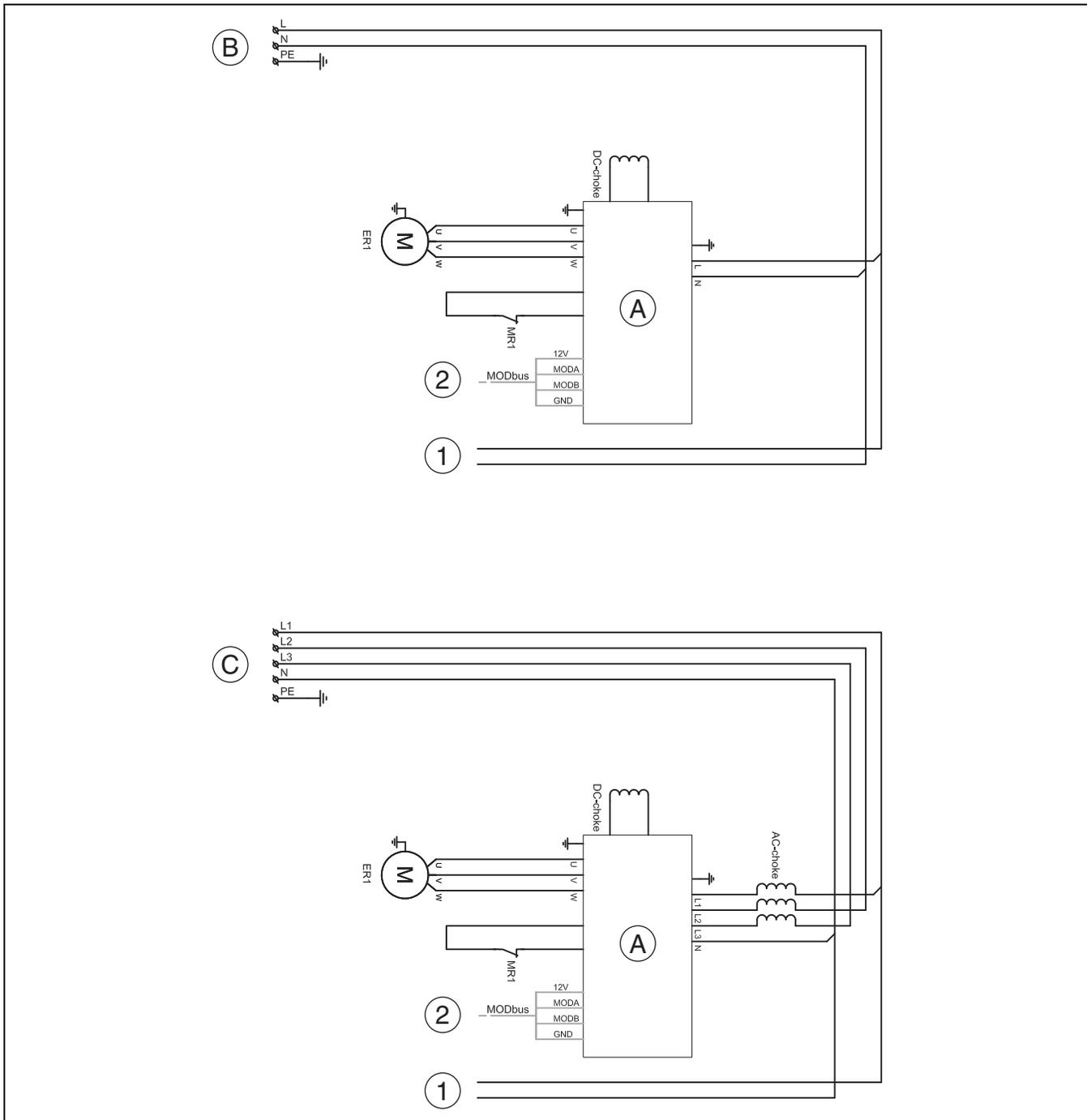
Bild 24 Schaltplan für Umformer, Wechselstrom / Drehstrom
