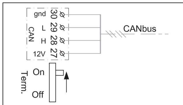
Bild 18 CAN-BUS-Terminierung
