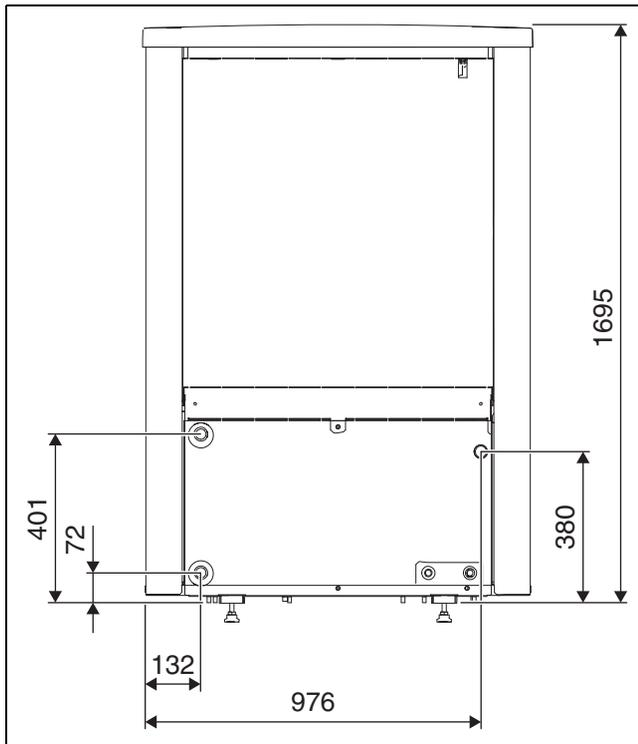
Bild 6 Abmessungen und Anschlüsse der Wärmepumpenmodelle 11.2-14.2
