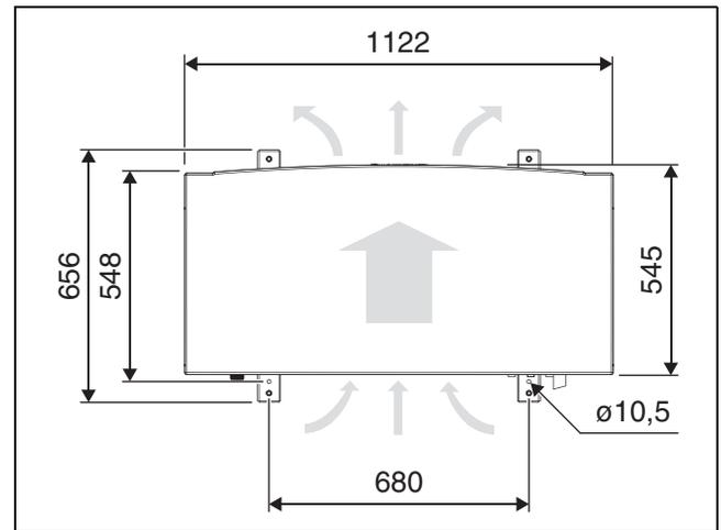
Bild 7 Abmessungen der Wärmepumpenmodelle 11.2-14.2, Ansicht von oben
