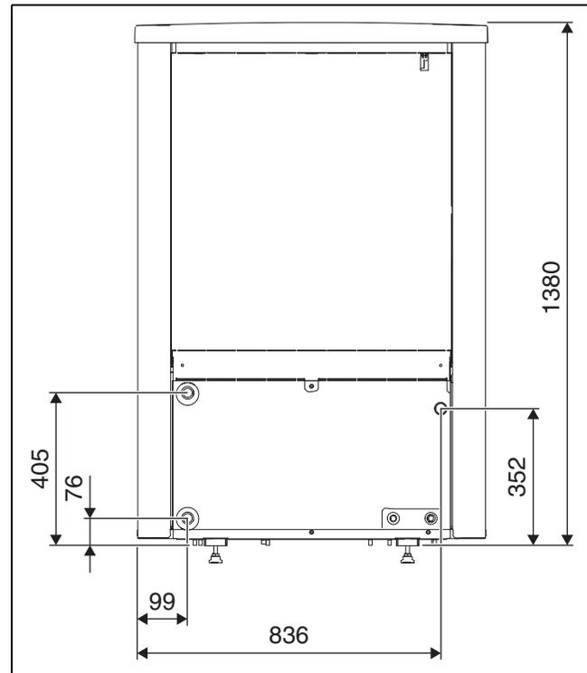
Bild 4 Abmessungen und Anschlüsse der Wärmepumpenmodelle 4.2-8.2, Rückseite
