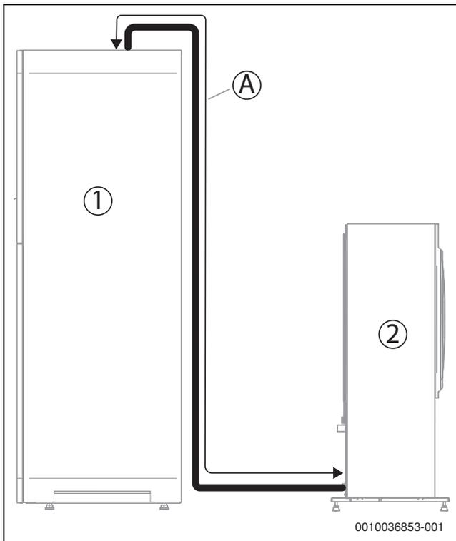
Bild 15 Rohrlänge A
