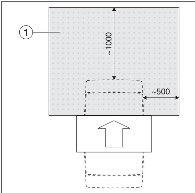
Bild 11 Gefahr! Eisbildung vor Wärmepumpen mit Lärmschutzhauben (Zubehör)
