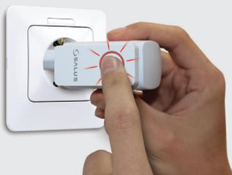
**5 Um die Systeminstallation fortzusetzen, Taste 5 Sekunden oder bis sie rot aufleuchtet gedrückt halten. Dies bedeutet, dass das Zigbee Netzwerk iT600 Geräte akzeptieren kann.**
