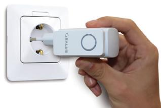
**3 Verbinden Sie den Adapter mit dem 230 V Netzteil.**
