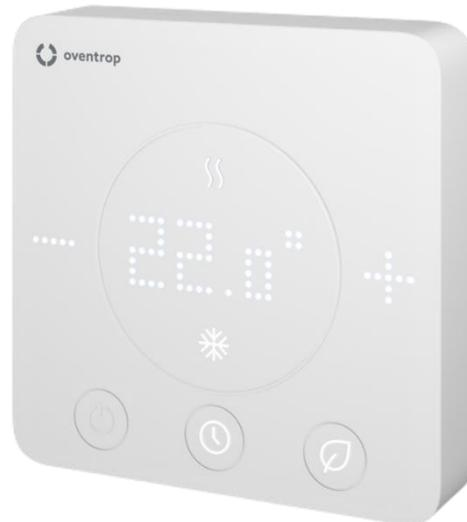
Die Raumthermostate ClimaCon F dienen der Temperaturregelung von Flächenheizungs- und -kühlanlagen sowie von Heiz- und Kühldecken in Einfamilienhäusern oder Wohnungen. Die Raumtemperatur wird über ein Ventil geregelt, welches von dem Raumthermostat über einen elektrothermischen Stellantrieb gesteuert wird. Erreicht die Raumtemperatur die Solltemperatur, wird das Ventil geschlossen.
