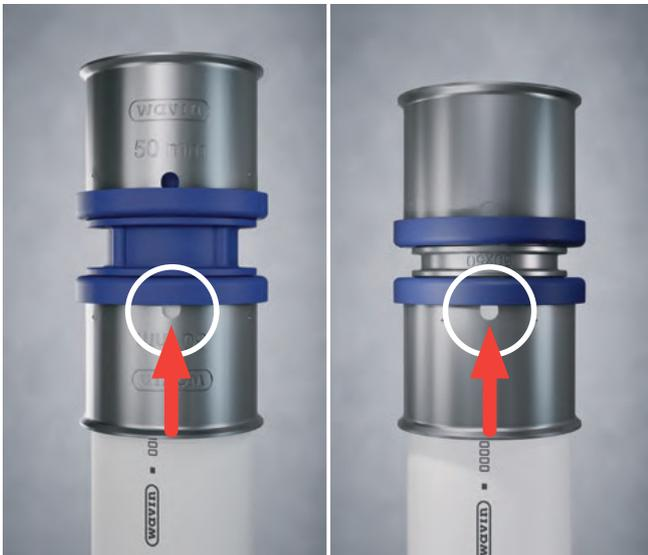
Abb. 10: Mit dem Sichtfenster lässt sich visuell prüfen, ob ein Rohr korrekt eingesteckt wurde
