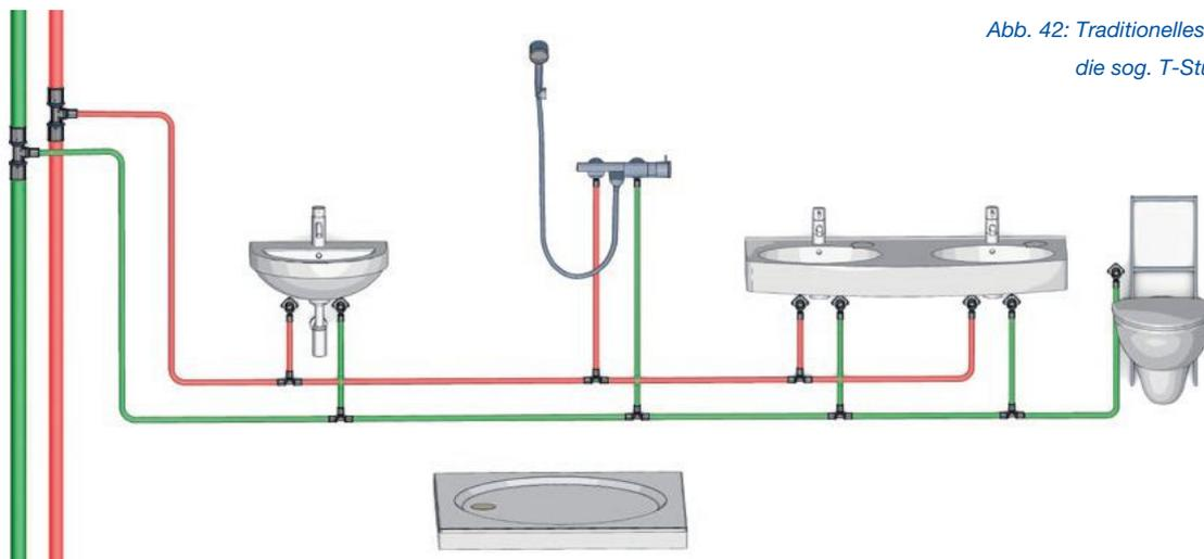
Abb. 42: Traditionelles Verteilsystem, die sog. T-Stück Installation
