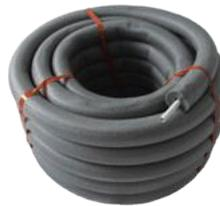
3. Wavin Mehrschicht-Verbundrohr ist im Ringbund mit **26 mm** Dämmung (Wärmeleitfähigkeit = 0,040 W/m·K) lieferbar. Dieses System entspricht der erforderlichen Dämmstoffstärke für Leitungen bis 22 mm.
