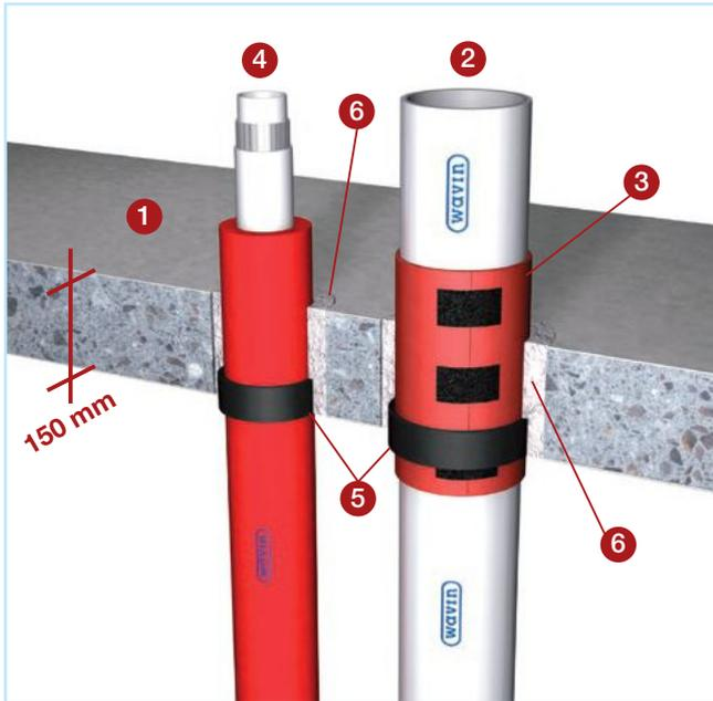
Bild 1: Gerade Rohrleitung durch Decke.
