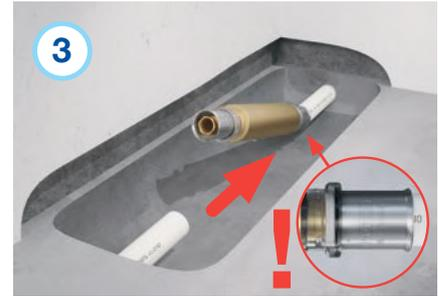
Sicherstellen, dass die Rohroberfläche völlig glatt und sauber ist. Einen Anschluss der Reparaturkupplung auf eines der freien Rohrenden setzen. Im Sichtfenster korrektes Einschieben des Rohrs prüfen.
