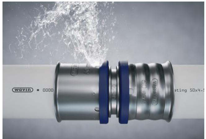
Abb. 16: SOLL-LECKAGE-Druckprüfung zeigt mit auslaufendem Wasser den unverpressten Fitting an
