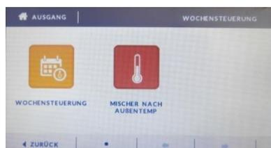
In der Wochensteuerung können zeitliche sowie temperaturabhängige Einstellungen der Heizkreispumpe getätigt werden.
