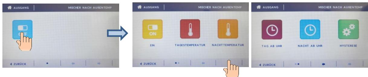
Tagestemperatur: nach Überschreitung dieser Außentemperatur bleibt die Heizkreispumpe ausgeschaltet
