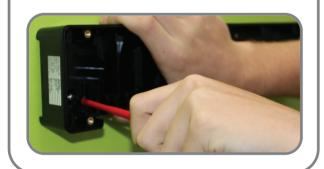
Montieren Sie die Leitung für Spannungsversorgung wie unten abgebildet.
