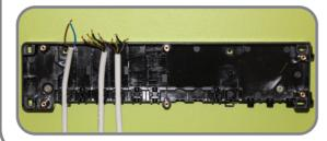
9 Montieren Sie die Leitungen der Stellantriebe wie unten abgebildet in der KL08NSB. Sie können bis zu 4 Stellantriebe je Zone anschliessen.
