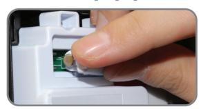
Montieren Sie die rote Zugentlastung mittels der drei Schrauben um die Pumpen/Boiler Leitungen sicher auf der Unterseite der KL08NSB zu befestigen.
