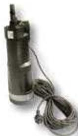
Mehrstufige, mediengekühlte Tauchpumpe für Garten und Haus. Die Pumpe besitzt einen integrierten Druckflusswächter mit elektronischer Ein- und Ausschaltautomatik. Aufgrund des integrierten Durchflusswächters gewährleistet sie ein sicheres Abschalten im Trockenlauf, Fördermenge maximal 5,7 m<sup>3</sup>/h, Anlagenhöhe maximal 20 m, Anlagendruck maximal 3,6 bar und Eintauchtiefe maximal 8 m.
