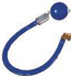
Schwimmende Entnahme bestehend aus PE-Schwimmkugel, Ansaugfilter mit integriertem Messing-Rückschlagventil und Klemmfitting für PE-Wasserrohr 1". Die schwimmende Entnahme ist einbaufertig montiert. Die Spezialschlauchlänge ist 2 m.
