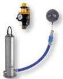
Komplettes Wasserversorgungspaket für Regenwassernutzungsanlagen: Unterwassermotorpumpe für vollständig oder teilweise eingetauchten Dauerbetrieb, Einbautiefe maximal 20 m, inklusive Schaltautomat KIT O2 und schwimmender Entnahme. Einsetzbar in Verbindung mit dem Roth Nachspeisemodul RON Komfort. Förderströme maximal 6 m<sup>3</sup>/h, Förderhöhe maximal 55 m, Einschaltdruck 2,4 bar, maximaler Anlagenenddruck 10 bar und maximale Anlagenhöhe 20 m.
