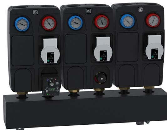
Die LK HydronicGroup ist eine komplette Pumpengruppe und eignet sich für Heizsysteme, bei denen eine Direktversorgung oder Nebenversorgungsleitung gewünscht wird. Besteht aus einer hocheffektiven Zirkulationspumpe, Isolierung, Konsole für die Wandmontage und zwei Kugelventilen mit Thermometer. Auf der Rücklaufseite gibt es ein integriertes Rückschlagventil.
