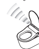
Personensensor A (Erkennt Änderungen der Wärme)
