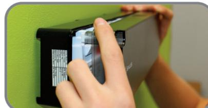
**12** Für seitliche Montage montieren Sie das kurze Flachbandkabel zwischen KL08NSB und KL04NSB (unten abgebildet). Bei abweichender Montage verwenden Sie das lange Flachbandkabel.
