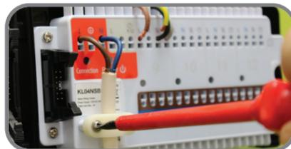
**9** Montieren Sie die Leitungen für die Thermostate wie unten abgebildet.
