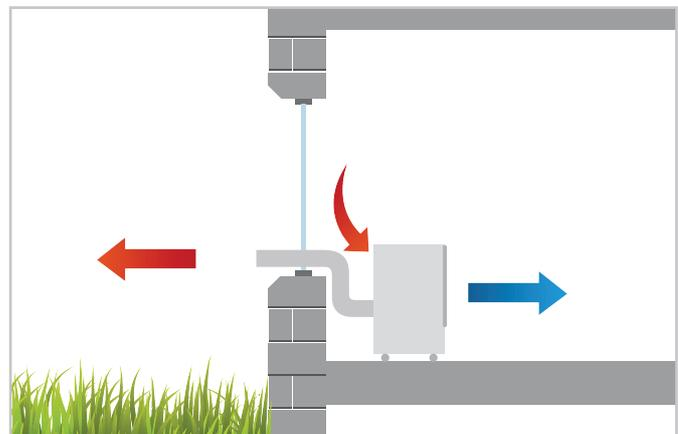
Die angesaugte Luft wird gefiltert, entfeuchtet und gekühlt dem Raum wieder zugeführt. Durch einen flexiblen Abluftschlauch wird die Wärme nach außen geleitet. Dafür brauchen Sie ein Fenster oder eine Tür nur einen Spalt weit zu öffnen. Die Feuchtigkeit wird als verdampftes Kondensat durch den Abluftschlauch nach außen geleitet.
