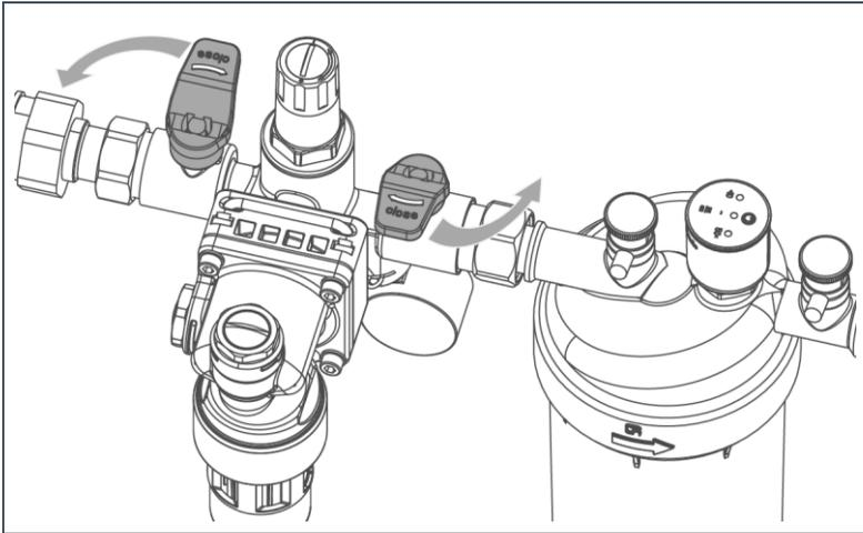
4. Öffnen Sie langsam das Absperrventil Trinkwasser (Eingang).
