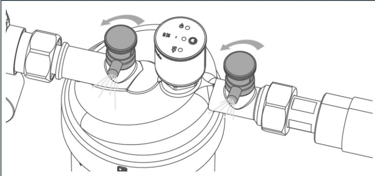
6. Öffnen Sie die Entlüftungsventile.
