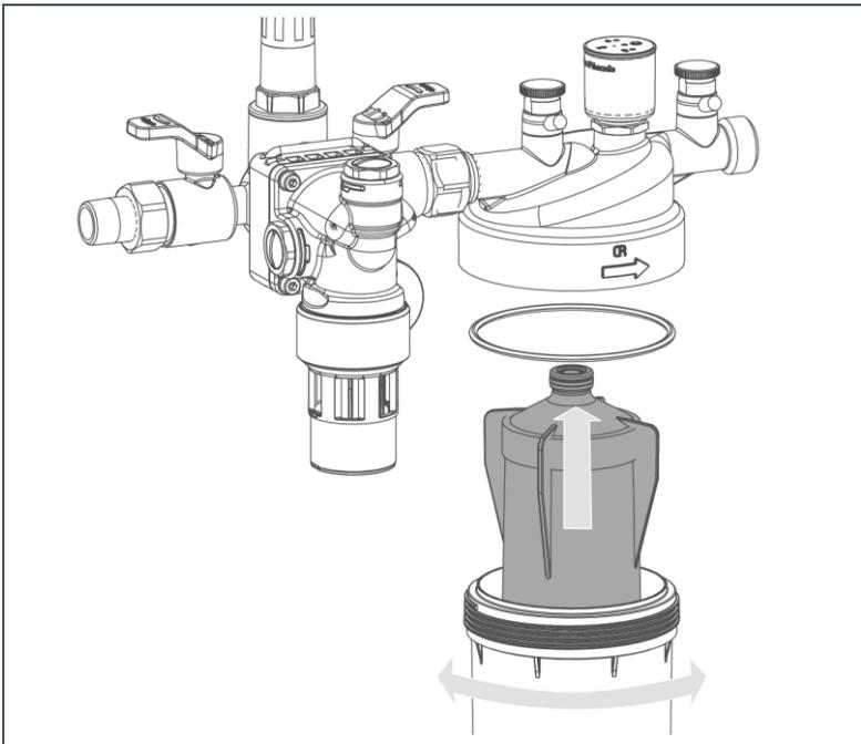
3. Demontieren Sie die Kunststoffglocke (Drehrichtung links).
