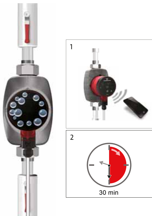
Abb. 7 Entlüften der Pumpe
