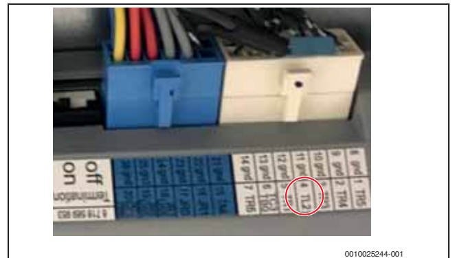
Bild 12 Referenzfühler TL2 an der I/O-Modul-Platine
