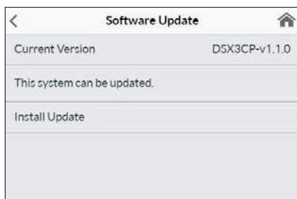
**Opmerking:** Koppel de stroomtoevoer van de boiler niet los tijdens het bijwerken van uw DSX Touch.
