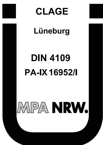
Du fait de la réglementation nationale sur la construction, un certificat de contrôle général émis par le centre technique du bâtiment est délivré pour cet appareil pour justifier de son aptitude à l'utilisation du point de vue des émissions sonores.
