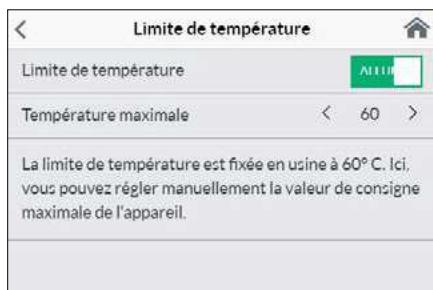
**Limite de température :** Ce menu permet d'activer/désactiver la limitation de la température ainsi que de limiter la température de sortie maximale à 'n'importe quelle valeur située dans la plage des températures en tapant sur < ou >.
