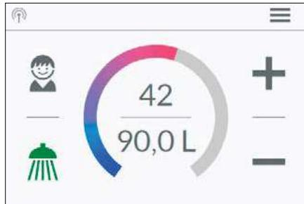
**Füllmenge:** Tippen Sie unter »Füllmenge« auf < oder > um die gewünschte Wassermenge einzustellen und danach auf »START« um die Automatik zu aktivieren. Die Ansicht wechselt in die Hauptsteuerung in der die eingestellte Menge direkt unter der Temperaturanzeige dargestellt wird. Öffnen der Warmwasserarmatur startet die Funktion und die eingestellte Füllmenge wird in Literschritten nach Durchflussmessung herunter gezählt.
