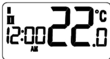
Die Anzeige ermöglicht ein leichtes ablesen der Raumtemperatur und der Status des Heizungssystems.
