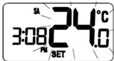
Wenn der Thermostat sich im temporär im manuellem Modus befindet, wird die Uhrzeit und der Tag angezeigt, zusammen mit dem „SET“-Symbol; alle anderen Informationen verschwinden von der Anzeige. Die eingestellte
