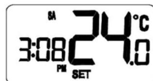
Beim temporär-manuellem Modus der programmierten Temperatur im Betrieb wird die LCD-Anzeige die aktuelle Soll-Temperatur anzeigen:
