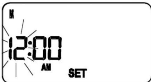
Die Zeit und der Tag werden zusammen mit "SET" angezeigt, während alle anderen Felder vom Display verschwinden. Die Stundenanzeige der Uhrzeit blinkt und zeigt dadurch an, dass sie ausgewählt ist und nun geändert werden kann.
