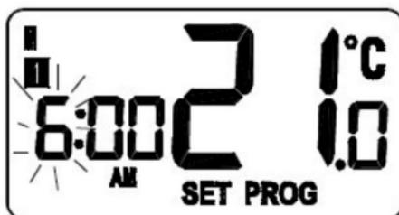
Drücken Sie die "SET"-Taste während des Programmiermodus, um in den Normal-Modus des RT500 zurückzukehren. Drücken Sie die "SELECT"-Taste um den ausgewählten Tag zu bestätigen. Danach wird die Stundenanzeige anfangen zu Blinken, um anzuzeigen, dass sie ausgewählt ist und eingestellt werden kann.
