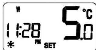
Im Betrieb des Frostschutzmodus, wird die LCD-Anzeige „5°C“ anzeigen und den aktivierten Frostschutz einblenden:
