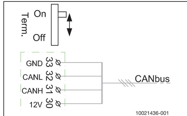
Bild 15 CAN-BUS-Terminierung
