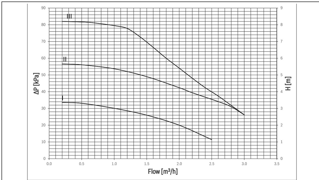
Bild 43 Restförderhöhe Heizkreispumpe für den Anschluss an den ungemischten Heizkreis für PC1 im Betrieb mit konstanter Drehzahl
