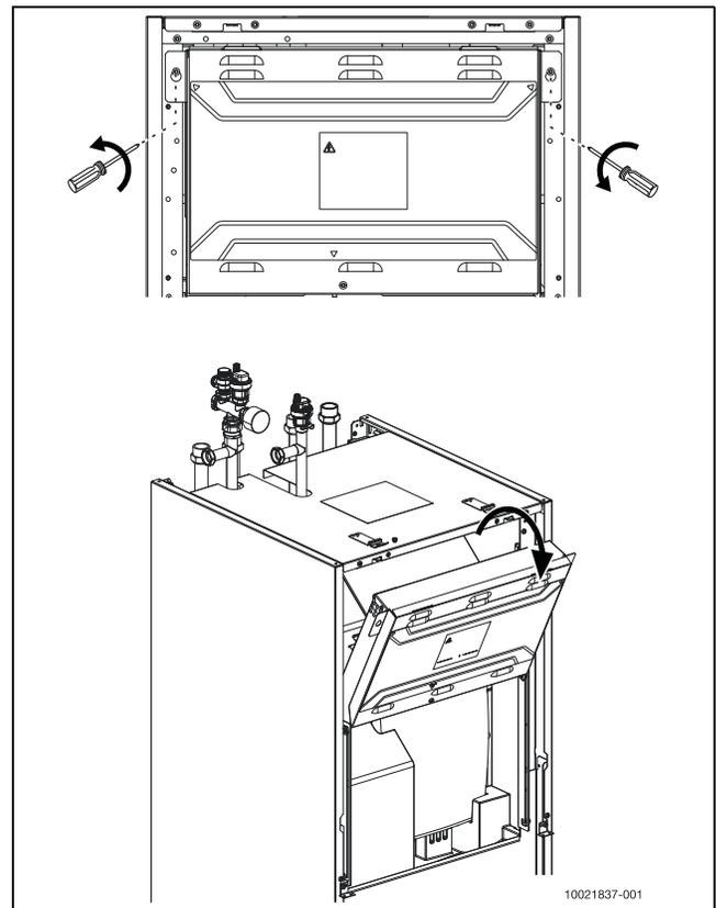
Bild 28 Klemmenkasten
