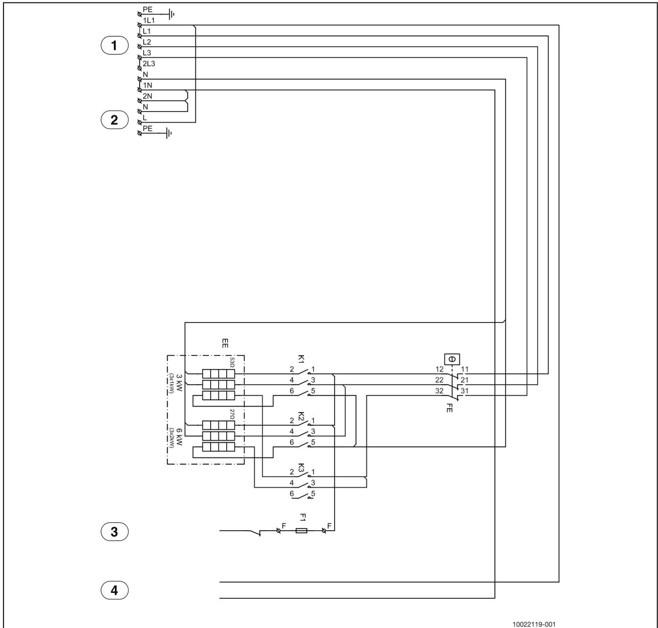
Bild 53 Spannungsversorgung Wärmepumpe und Inneneinheit 9 kW
