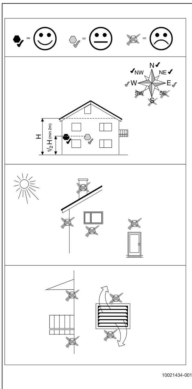
Bild 16 Anordnung des Außentemperaturfühlers
