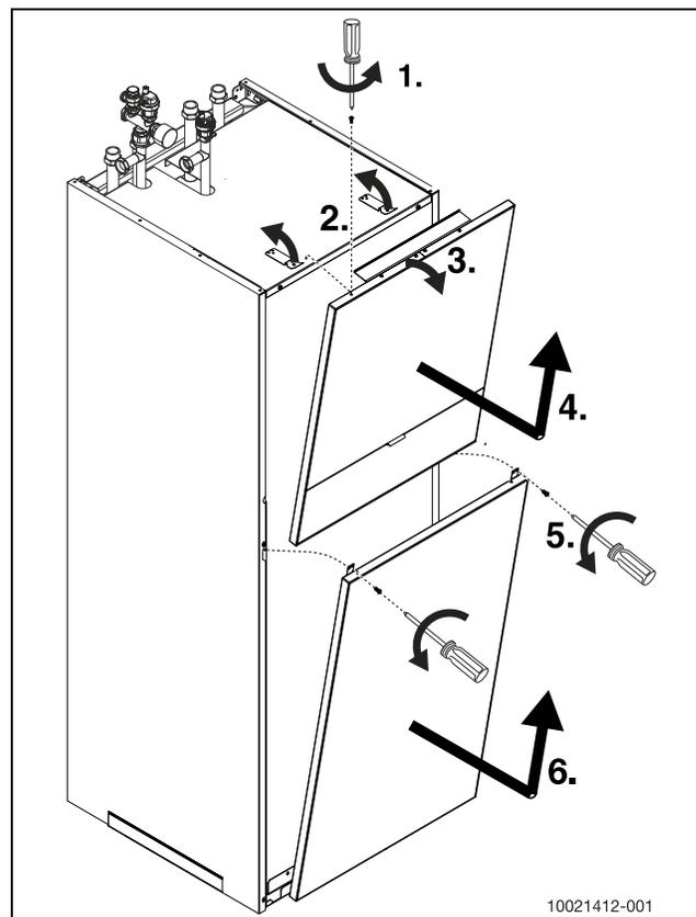
Bild 10 Abdeckungen entfernen
