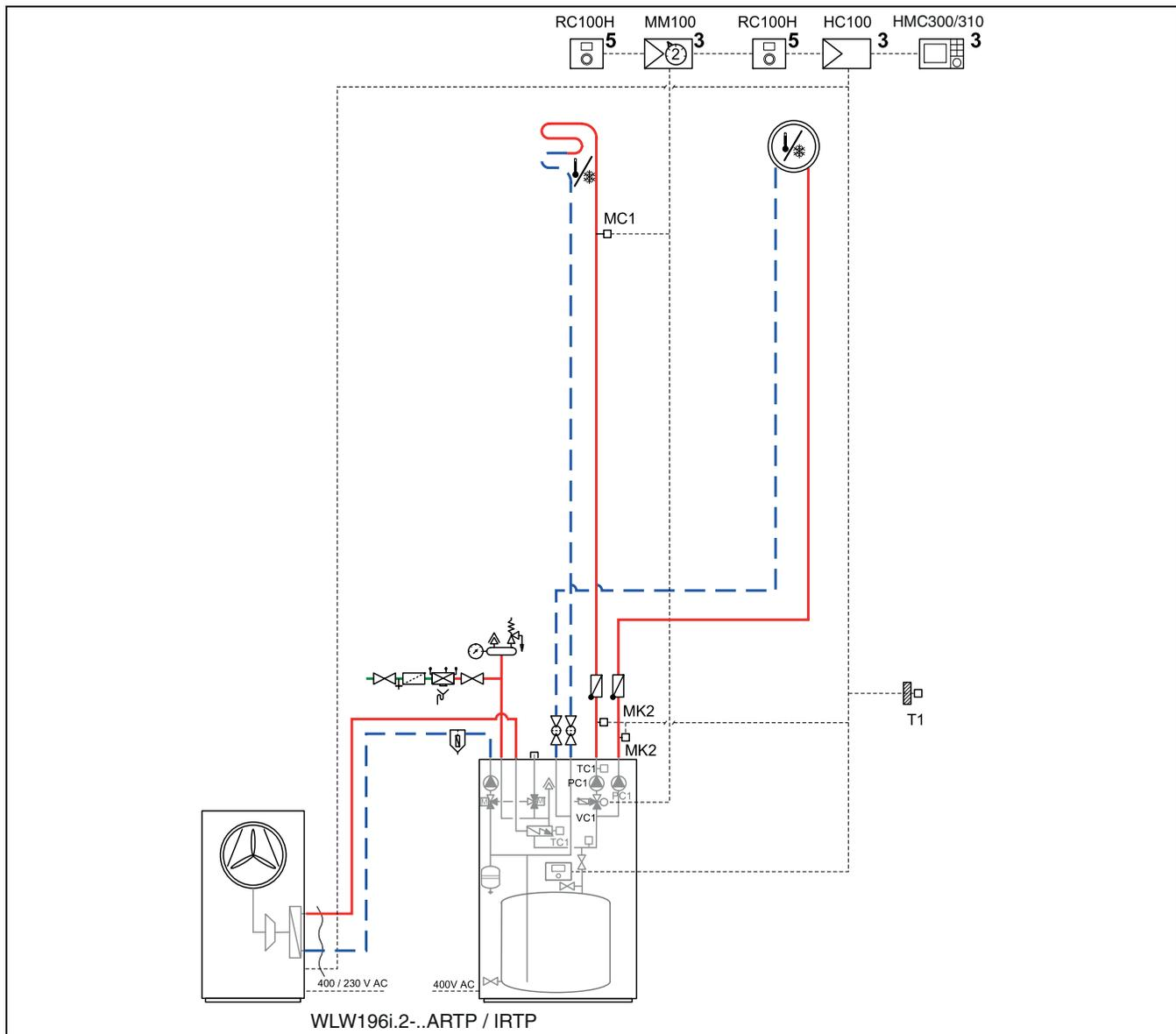
Bild 49 Wärmepumpe, Inneneinheit mit einem gemischten und einem ungemischten Kreis ohne WW
