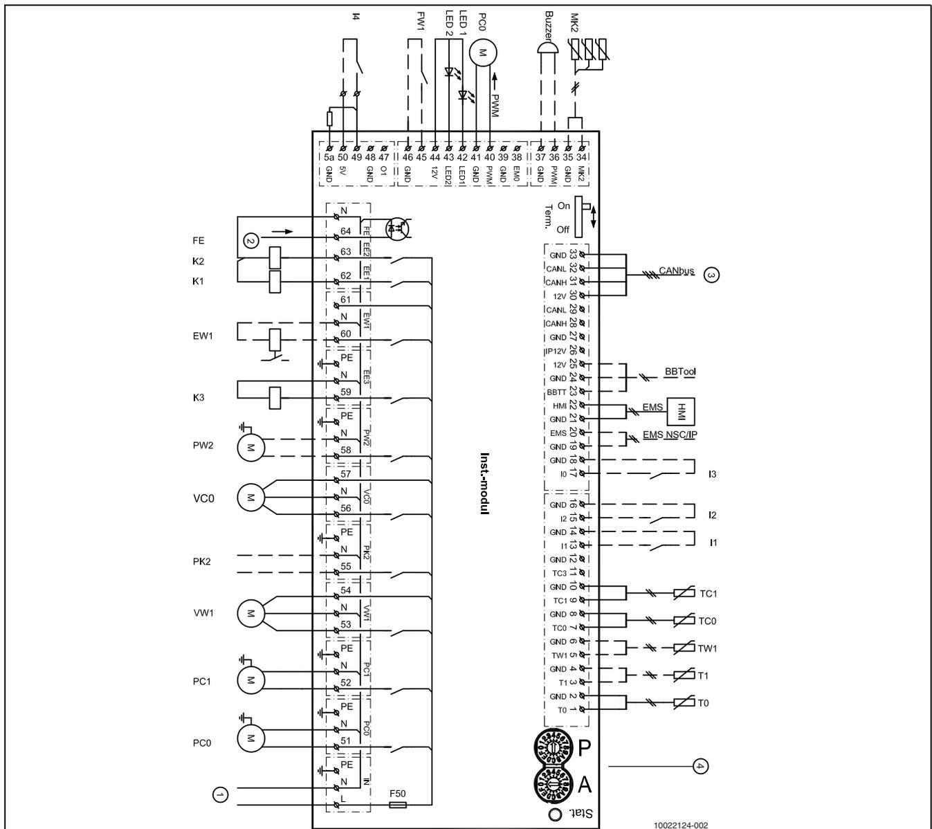
Bild 55 Schaltplan Installationsmodul
