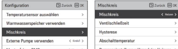
Sie können die Ventilschließzeit [s] und die Hysteresetemperatur [°C] auf dem Bildschirm selbst einstellen. Die Einstellung der Abschalttemperatur schützt davor, dass das Wasser während des Heizbetriebs oberhalb der Abschalttemperatur in den Mischkreis fließt.
