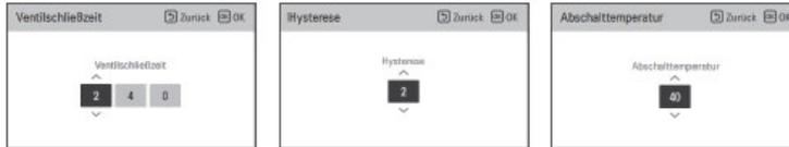
Installer-Einstellungsfunktion zur Einstellung des Wassermischpumpenbetriebs / der Verzögerungszeitoption im Heiz- / Kühlmodus
