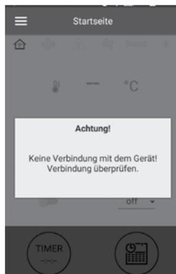
Standardmäßig funktioniert der Ventilator als WLAN-Zugangspunkt. Verbinden Sie nach Installation der App das Mobilgerät mit dem Ventilator als WLAN-Zugangspunkt mit dem Namen (**FAN: + 16 Zeichen der ID-Nummer**), wie auf der Steuerplatte und dem Gehäuse der Anlage angegeben.
