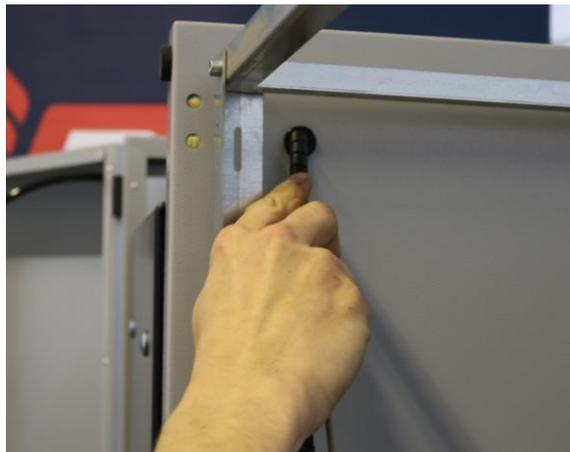
Abdeckung der Brennerplatte nach oben ausklinken
