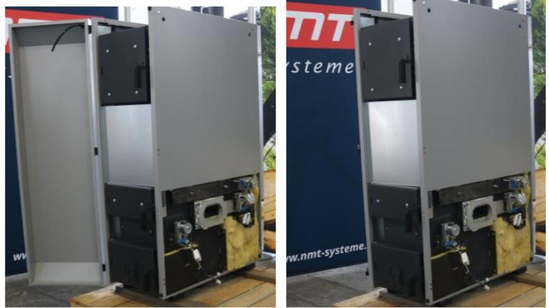
Abdeckung des Hebels der Wärmetauscherreinigung demontieren.
