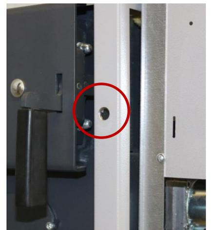
Kabel des Steuerungstableaus durch die Seitenverkleidung (Mitte) ziehen
