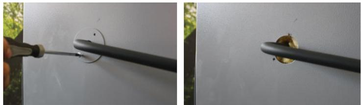
Schrauben an der Rückwand lösen und hintere Verkleidung entfernen.
