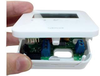
Entfernen Sie vorsichtig das Frontgehäuse und schließen Sie die Kabel an.
