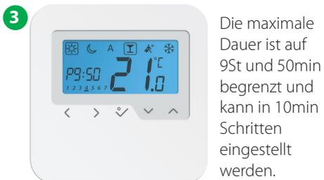
Um den Partymodus zu verlassen, bewegen Sie auf einen anderen Modus. Sobald der Partymodus verlassen wird, ist dieser automatisch auf 0 zurückgesetzt.
