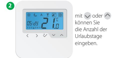
**Hinweis:** Urlaubsmodus endet wenn der Tag 0 erreicht wird. Das Gerät arbeitet dann wieder im Automatikbetrieb.
