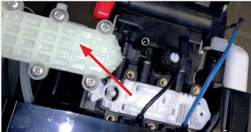
Entfernen Sie die Halterung des Dichtungs-Sets.
