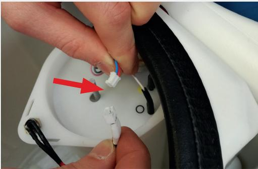
Lösen Sie die Steckverbindungen der LED der Salzbehälterbeleuchtung.
