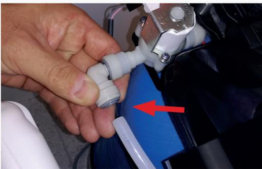
Entfernen Sie den roten Sicherungsring.
