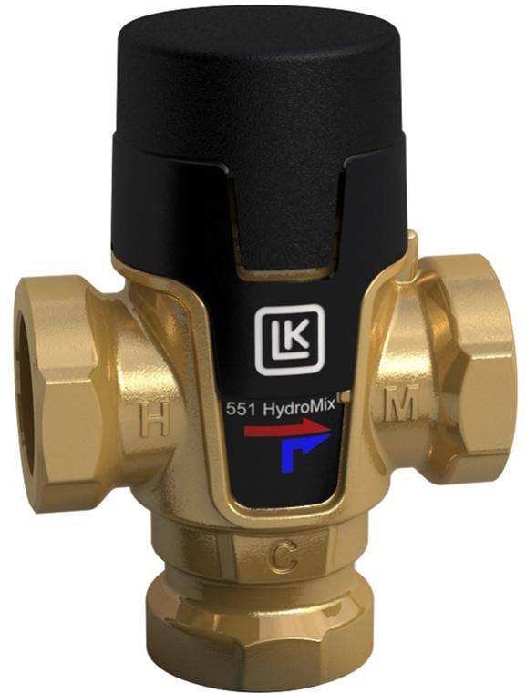
LK 551 HydroMix ist ein asymmetrisches Mischventil für die Warmwasserbereitung und Heizsysteme. Das Mischventil hat einen thermischen Einsatz zur Regelung der Warmwassertemperatur. Es regelt sowohl die Heißwasser- als auch die Kaltwasserzufuhr um die gewünschte Temperatur zu erreichen. Das Ventil hat einen Verbrühungsschutz, der den Zufluss von heißem Wasser bei Ausfall der Kaltwasserzufuhr unterbricht.
