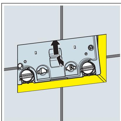
► Die Abdeckplatte in den Spülkasten einsetzen.
