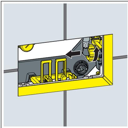
► Den Flexschlauch am Füllventil lösen.
