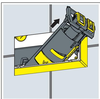
► Das Ablaufventil durch die Revisionsöffnung entnehmen.
