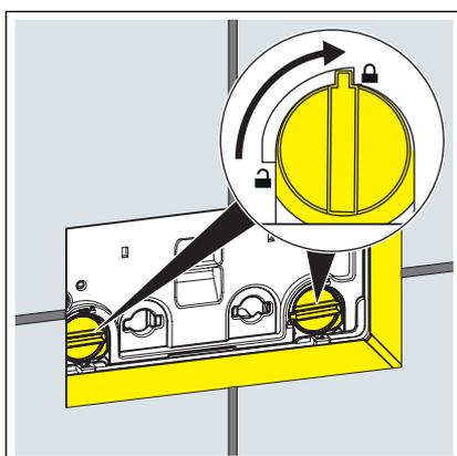
► Die Verriegelung der Abdeckplatte um 90° im Uhrzeigersinn drehen.
