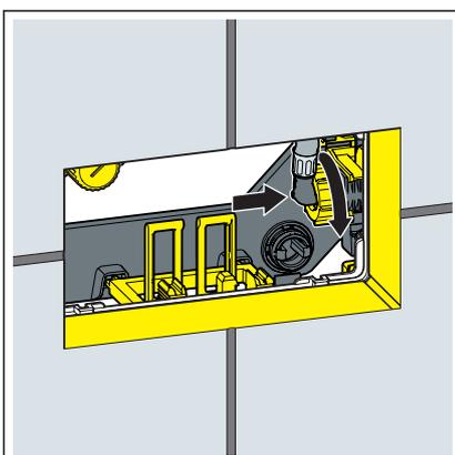
► Den Flexschlauch am Füllventil anschließen.
