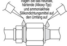
Das neutrale, härtende (Alkoxy-Typ) und ammoniakfreie Silikonichtungsmittel wird erst nach dem Drucktest und Reinigen und nur auf die Außenseite des Anschlusses unter Beachtung der folgenden Anweisungen angebracht. Ziel ist es, dass keine Feuchtigkeit in die Fugenverbindung gelangt und dass vor Frost geschützt wird. Das Härten des Dichtungsmittels wird etwas Zeit in Anspruch nehmen. Stellen Sie sicher, dass sich das Dichtungsmittel beim Isolieren nicht ablöst.
