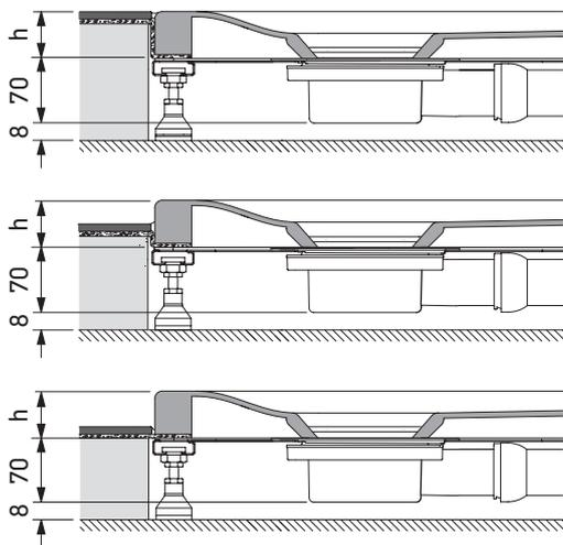
Intelaiatura di base regolabile in altezza di 70 – 100 mm, con piedi piatto doccia per montaggio rialzato a pavimento (# 790173) regolabile in altezza di 100 – 150 mm.
