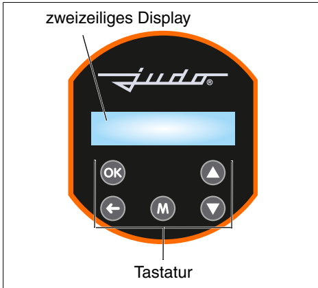
Abb. 11: Bedienfeld der Enthärtungsanlage
