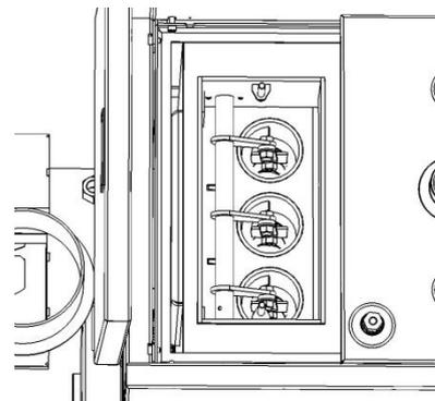
Abb. 8: WT-Röhren mit Turbulatorspiralen
