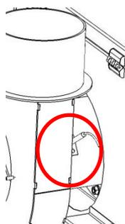
Die Befestigungsschraube lösen und den Fühler aus dem Rauchrohr ziehen.
