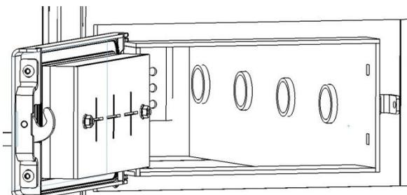
Abb. 13: Kesselwand/ Primärluftöffnungen
