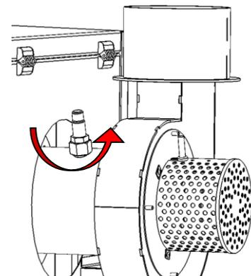
Abb. 15: Lambdasonde im Rauchrohr
