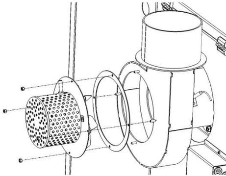
Vier Verbindungsschrauben zwischen Ventilator, Dichtung und Abgasumlenkung lösen.
