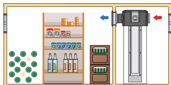
Beim Betrieb mit Raumlufte kann die abgekühlte Luft z. B. in einen Vorratsraum geleitet werden.
