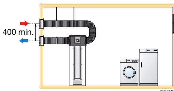
Beim Betrieb mit Außenluft wird je eine Leitung für die Zu- und für die Abluft gelegt. Die Leitungen haben 160 mm Durchmesser.
