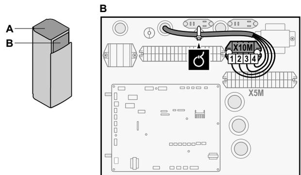
4 Fixieren Sie die Kabel mit Kabelbindern an den Kabelbinderhalterungen. Fixieren Sie bei Bedarf überschüssige Kabellänge mit einem Kabelbinder.
