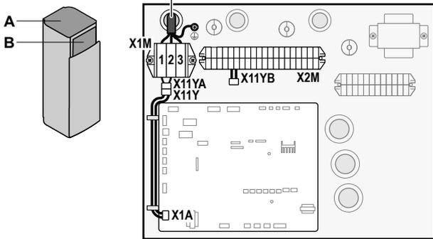
a Verbindungskabel (=Hauptstromversorgung)
