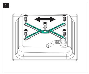
Kontermuttern der Höhenverstellungen lösen und den Duschwannenfuß auf die Duschwannengröße einstellen. Dazu können die Traversen geschwenkt und die Verbindungsplatte am Mittelfuß ausgezogen werden.
