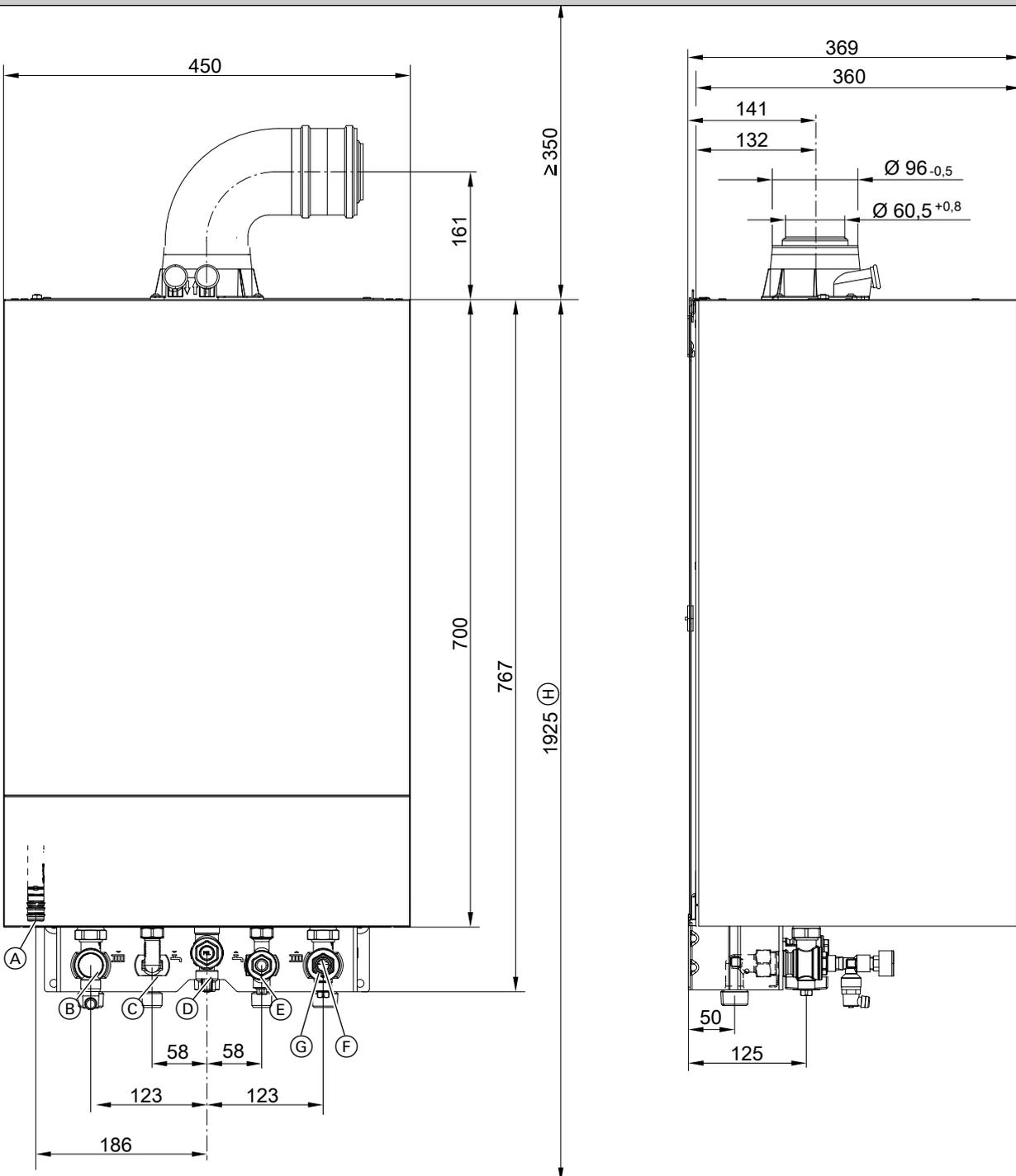
Abb. 2 Dargestellt Gas-Brennwertkombigerät
