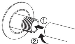
Zur Erleichterung des Abtrennens des Warmwasserbereiters für Wartung oder Austausch wird die Installation von Verschraubungen an den Wasseranschlüssen empfohlen.
