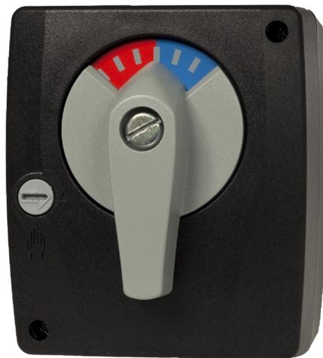
LK 950 ist eine Stellmotoren-Baureihe. Abhängig vom Modell kann der Antrieb mit 3-Punkt SPDT oder proportional 2 (0) -10 V Stellsignal angesteuert werden. Der Motor hat zwei Endlageschalter. Der Drehwinkel ist auf 90° elektrisch begrenzt. Ein potentialfreier, einstellbarer Hilfsschalter kann als Zubehör bestellt werden.
