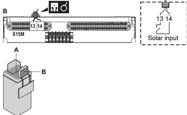
3 Befestigen Sie das Kabel mit Kabelbindern an den Kabelbinderhalterungen. Allgemeine Informationen finden Sie unter "6.3.1 Die elektrischen Leitungen an die Inneneinheiten anschließen" [▶ 17].
