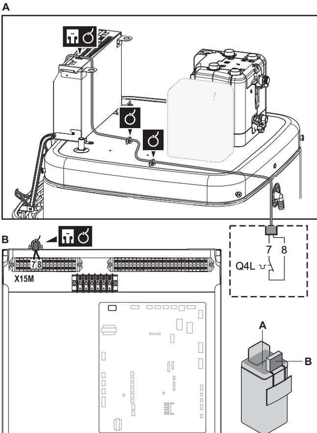
3 Befestigen Sie das Kabel mit Kabelbindern an den Kabelbinderhalterungen. Allgemeine Informationen finden Sie unter "6.3.1 Die elektrischen Leitungen an die Inneneinheiten anschließen" ▶ 17].
