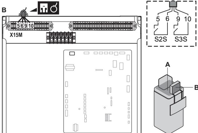
3 Befestigen Sie das Kabel mit Kabelbindern an den Kabelbinderhalterungen. Allgemeine Informationen finden Sie unter "6.3.1 Die elektrischen Leitungen an die Inneneinheiten anschließen" [▶ 17].
