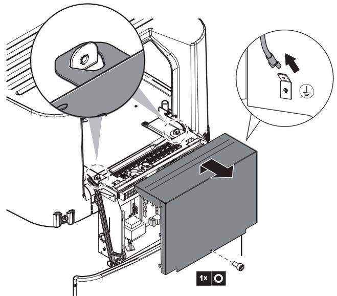
4 Wenn der Schaltkasten geöffnet wird: Trennen Sie den Erdleiter von der oberen Abdeckung des Schaltkastens.
