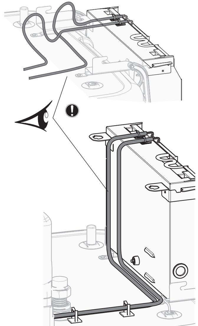
Alle Kabel, die an den Schaltkasten des ECH<sub>2</sub>O angeschlossen werden, müssen mit einer Zugentlastung fixiert werden.
