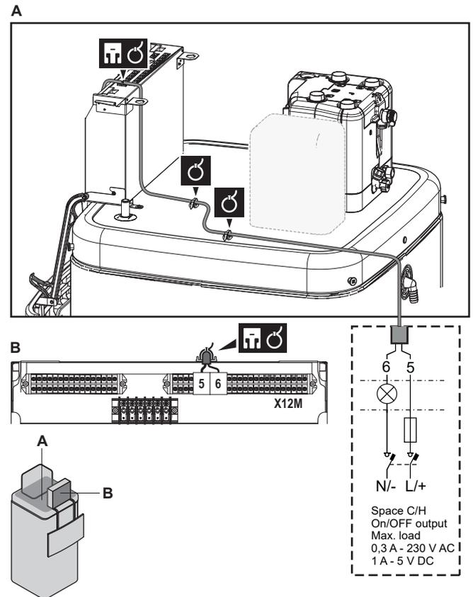
3 Befestigen Sie das Kabel mit Kabelbindern an den Kabelbinderhalterungen. Allgemeine Informationen finden Sie unter "6.3.1 Die elektrischen Leitungen an die Inneneinheiten anschließen" [▶ 17].
