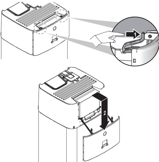
2 Entfernen Sie die Schaltkastenabdeckung.
