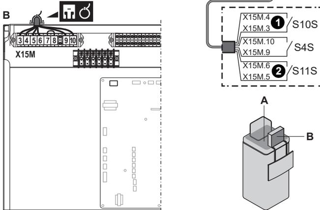
2 Fixieren Sie die Kabel mit Kabelbindern an den Kabelbinderhalterungen.
