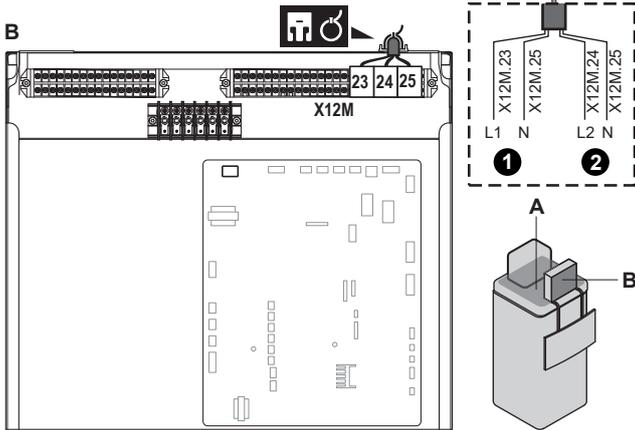
6 Befestigen Sie das Kabel mit Kabelbindern an den Kabelbinderhalterungen. Allgemeine Informationen finden Sie unter "6.3.1 Die elektrischen Leitungen an die Inneneinheiten anschließen" [▶ 17].
