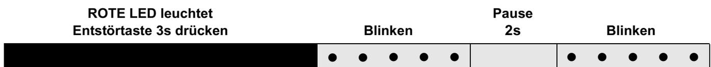
Die Sequenz der vom Steuergerät abgegebenen Impulse gibt die möglichen Defekte an, die in der nachfolgenden Tabelle verzeichnet sind.
