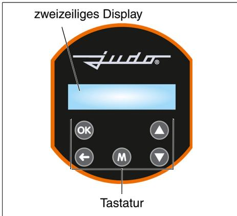
Abb. 8: Bedienfeld der Enthärtungsanlage
